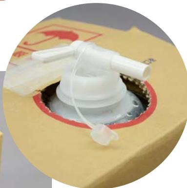
1. 付属の MRI 水溶液の容器の蓋をはずし、水溶液充填用コックを取り付けます。予めビーカー等の容器を用意し、コックを開きの状態にして、段ボール箱ごと容器を抱えて別の容器に水溶液を入れます。
